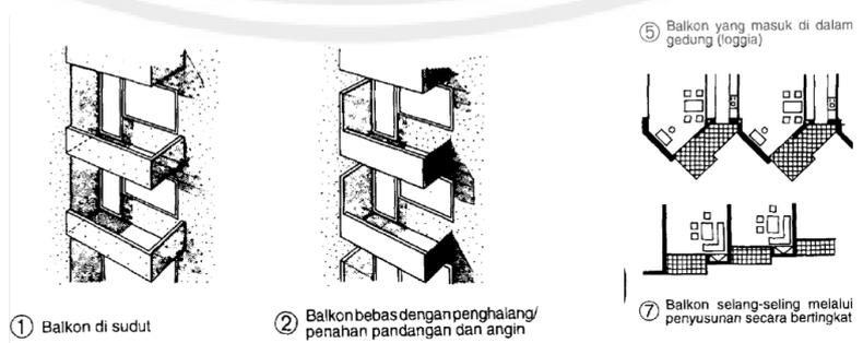
Gambar 2.21 Contoh desain balkon dan alternative penempatan balkon
